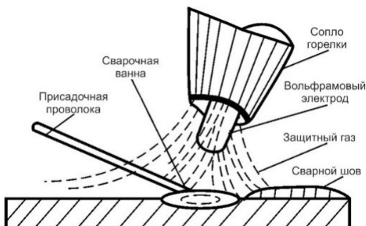
Рисунок 13.7. Схематический рисунок аргонодуговой сварки.
