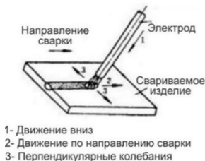
Рисунок 13.4 Три основных направления движения электрода
