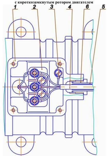
Для подключения токоподводящего кабеля к электровибратору необходимо:
