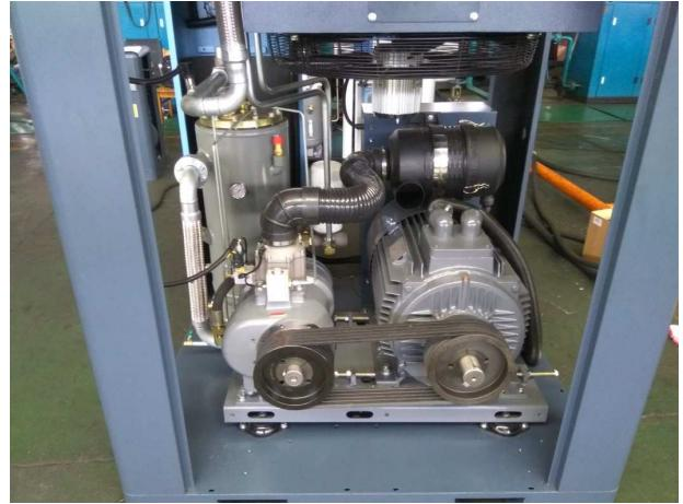
**NEW: В новой линейке SB применяется усиленный воздушный фильтр , для более эффективной фильтрации воздуха на входе.**
