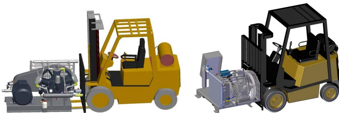
Рисунок 10. Транспортировка компрессора на погрузчике
