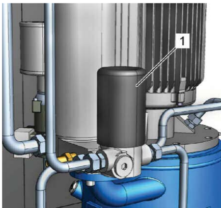
Рис. 38: Демонтаж фильтра охлаждающей жидкости
