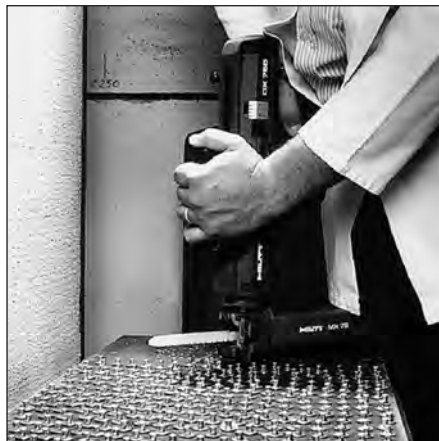
Испытание срока службы порохового монтажного инструмента с магазином для гвоздей
