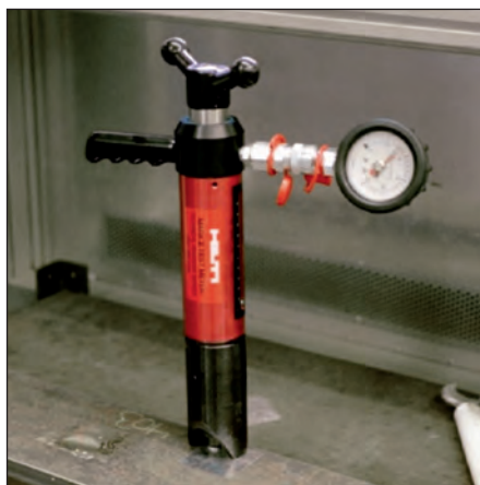
Тест на вырыв гвоздя ENP при помощи прибора Mark V и адаптера ENP
