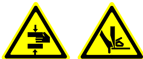
Рис. 5-1 Риск захвата или травмы пальцев
