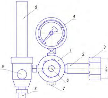
Рис. 1. Регуляторы расхода газа:
