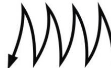
Прямые зигзагообразные движения применяют для получения наплавленных валиков при сварке встык без скоса кромок в нижнем положении и если нет вероятности прожечь деталь.
