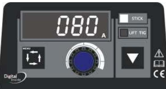
Рис 2 Индикация в режиме MMA
