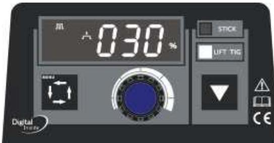
Рис 6 Заданный ток импульса в % от пикового
