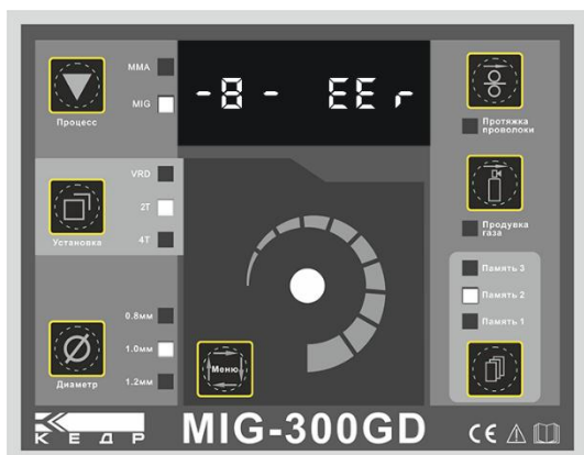
Изображение 12: Неисправный механизм подачи проволоки
