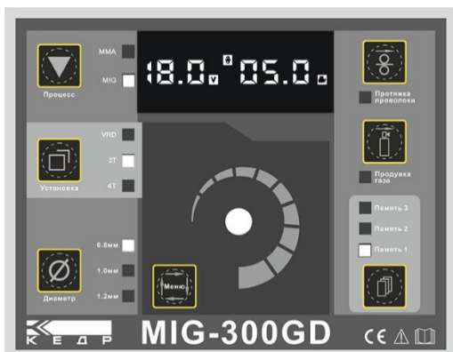
Изображение 5: Дисплей заданного напряжения при MIG сварке
