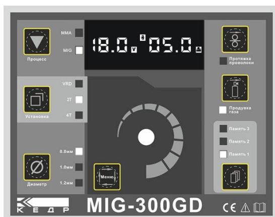
Изображение 7: Дисплей проверки наличия проволоки при MIG сварке
