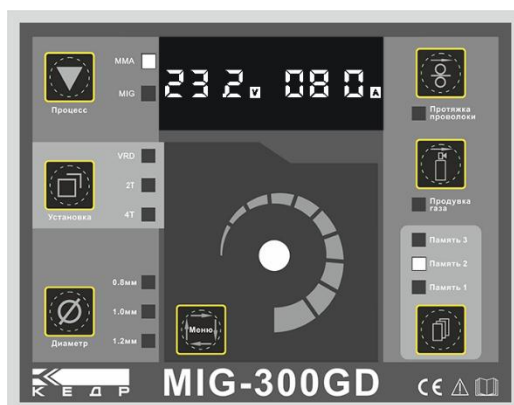
Изображение 4: Показатели дисплея при режиме сварки MMA
