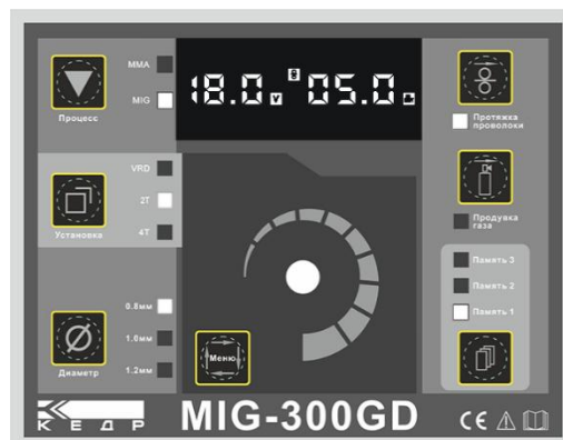
Изображение 6: Дисплей проверки проволоки при MIG сварке
