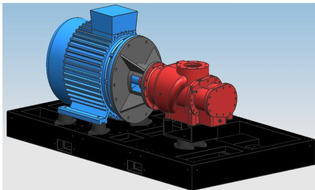
КПД данного привода составляет приблизительно 99.95% и, следовательно, он намного выше, чем у традиционных способов передачи (клиновременная – дополнительная нагрузка натяжения ремня на подшипники качения и шестеренчатая - дополнительный редуктор и увеличение инерционных нагрузок и ударов). Беспрерывно, в течение суток, работающие компрессоры серии **MD** вырабатывают больше сжатого воздуха, потребляя при этом меньше энергии не требуя дополнительного обслуживания.
