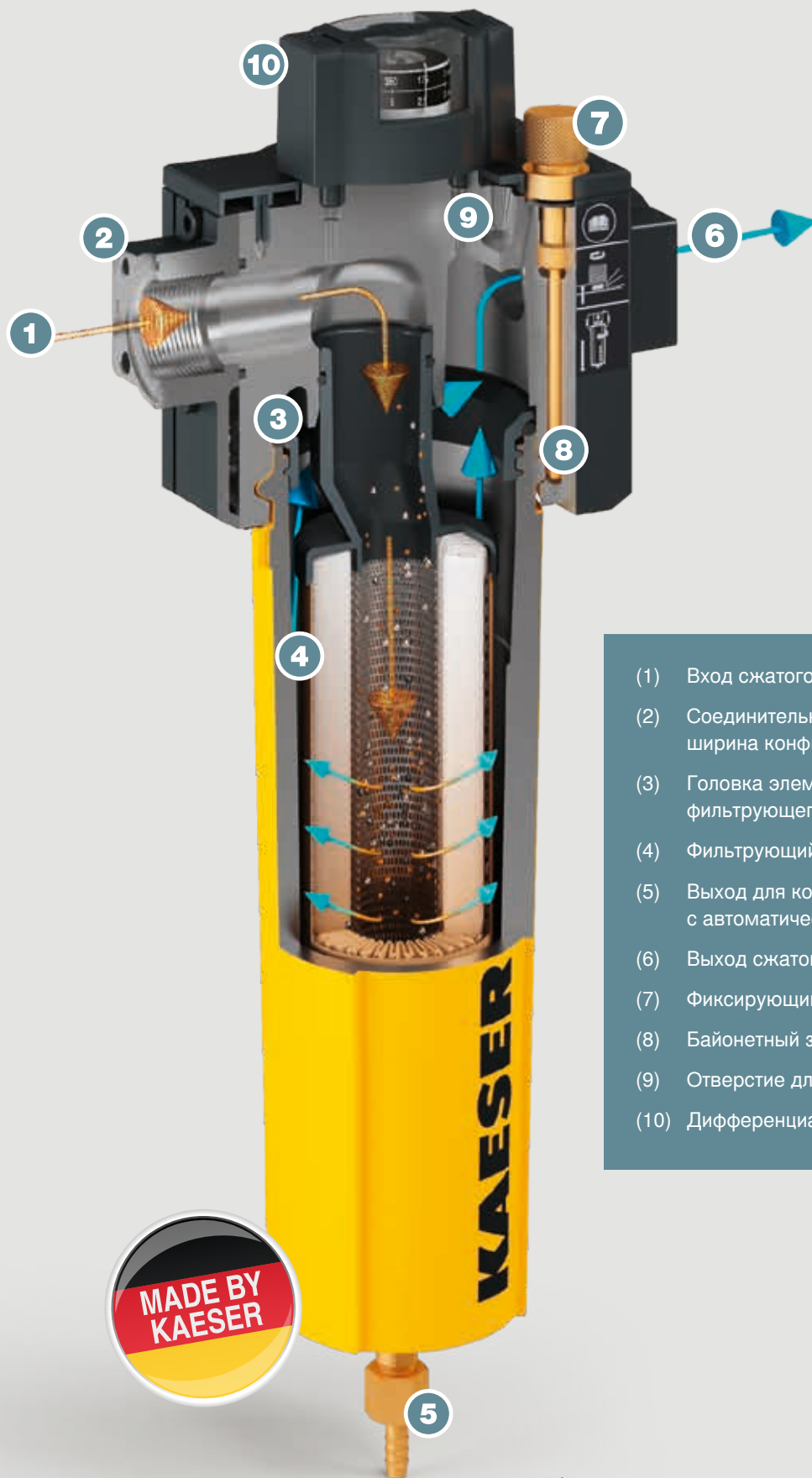
Рис.: Функциональная схема коалесцентного фильтра
