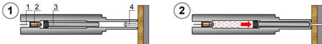
1. Боек. 2. Монтажный патрон. 3. Поршень. 4. Дюбель-гвоздь.
