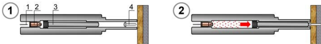
1. Боек. 2. Монтажный патрон. 3. Поршень. 4. Дюбель-гвоздь.
