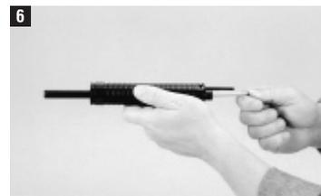
Вытолкните поршень из направляющей с помощью шомпола.
