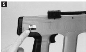
Проверьте регулятор силы заряда. Если регулятор отодвинут до конца назад, это означает максимальную мощность.
