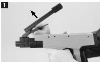
Откиньте вперед откидной затвор. Откройте крышку корпуса, нажав на соединительное устройство и подняв фиксатор.
