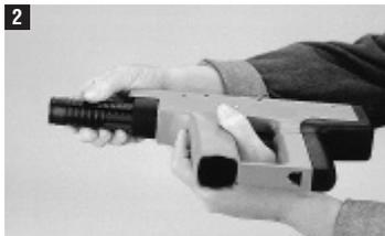
Вставьте направляющую с поршнем в корпус (желобок в направляющей должен быть подведен под глушитель).
