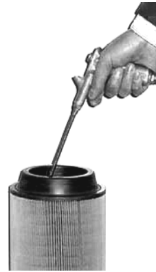
Рис. 6.3 Очистка фильтрующего элемента воздушного фильтра
