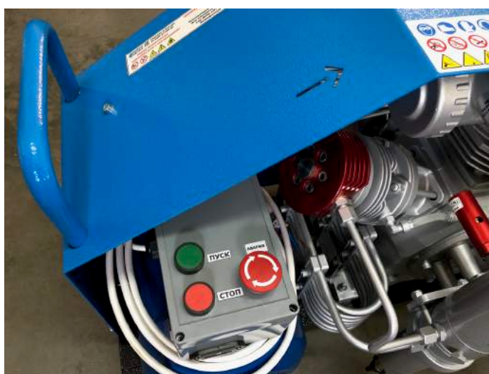
Рисунок 3 Кнопка аварийного останова
