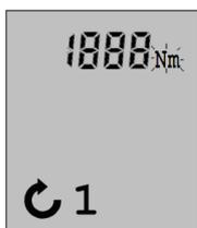
Теперь мигает «Nm», нажмите «+» или «-», чтобы установить необходимое значение крутящего момента, например 1888 Нм, затем нажмите «С» для подтверждения. Выберите направление вращения с помощью рычага реверса, нажмите кнопку пуска, и машина начнет работать. При достижении заданного значения крутящего момента машина автоматически прекращает работу.
