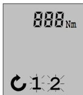
Нажмите «С», чтобы войти в интерфейс выбора передачи, «1» или «2» начнут мигать; Нажмите «+», чтобы выбрать необходимую передачу, например, передачу 1, затем нажмите «С» для подтверждения и переведите рычаг переключения передач в нужное положение;
