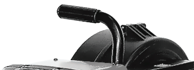
Рис. 2.1 Ручка для переноски механизма подачи проволоки
