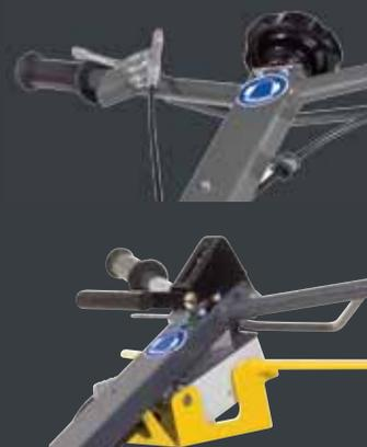
Два способа регулировки угла наклона лезвия: классическая поворотная рукоятка, плавно изменяющая угол или удобная для пользователя ручка быстрого переключения с восемью фиксированными положениями.
