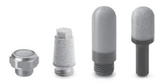
Глушители – это необходимые элементы для устранения или снижения шума во время выхлопа сжатого воздуха. Они всегда должны устанавливаться на выхлопные отверстия 3/2, 5/2 или 5/3 лин./поз. распределителей. Периодически в процессе эксплуатации глушители необходимо обезжиривать уайт-спиритом и продуть через них сжатый воздух в обратном направлении.
