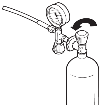
Рис. 9 Присоединение баллона сжатого воздуха
