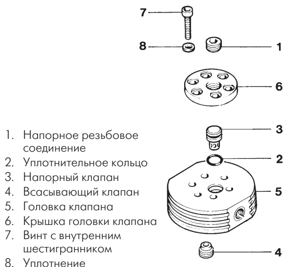
Рис. 29 Головка клапана 3-й ступени
