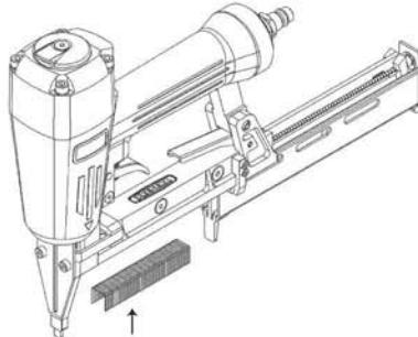
При наличии **системы верхней зарядки**, в зависимости от конструкции, необходимо оттянуть назад или верхнюю часть магазина после деблокировки, или толкатель забиваемой детали - вплоть до фиксации.
