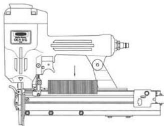
Толкатель деблокируется и вручную подводится к пакету, или же магазин перемещается вперед вплоть до фиксации.
